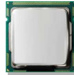
中央處理器 FC-BGA 37.5mm*37.5mm 3/2/3
